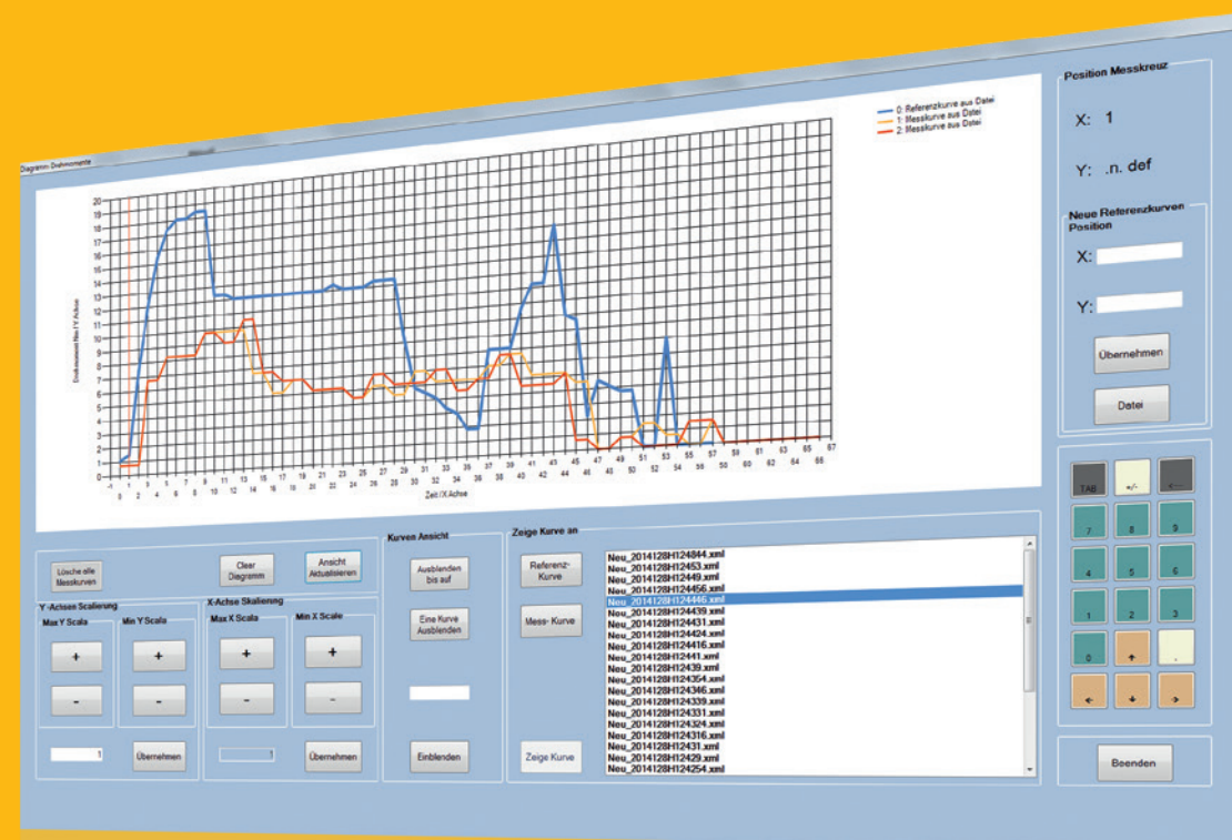
Drehmomentverlauf während Wickelvorgang
